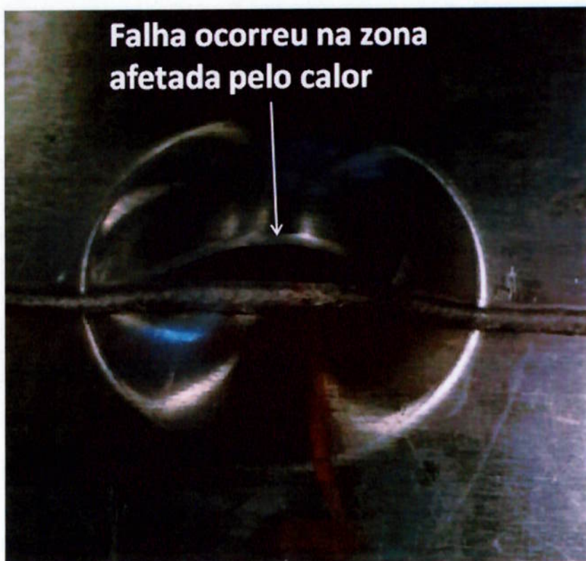
Figura 2.63 – Imagem do ensaio Erichsen E2.
