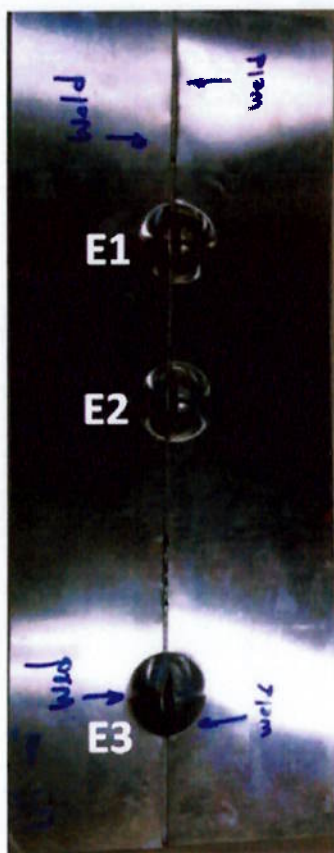
Figura 2.61 – Imagem do corpo de prova após os ensaios de embutimento Erichsen na junta soldada.
